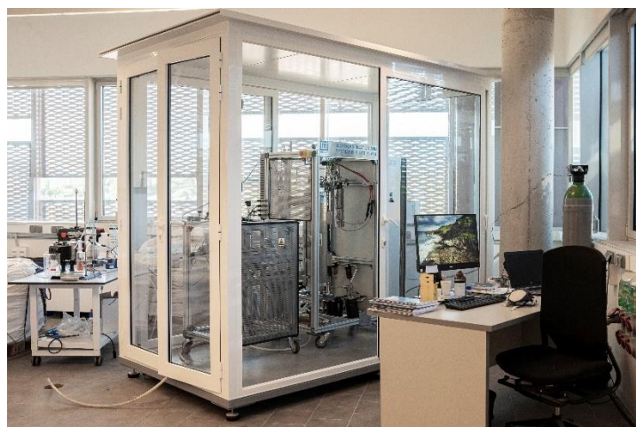
Figura 17 Planta de gasificación y pirólisis usada para las pruebas en laboratorio
