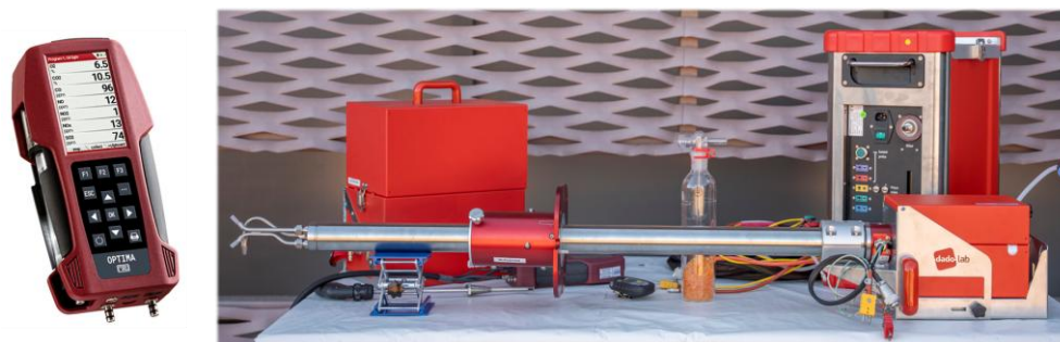
Figura 3 Equipamiento utilizado durante el proyecto para la medición de emisiones: Analizador compacto de gases (izquierda) y tren de muestreo isocinético para la determinación del material particulado (derecha).
