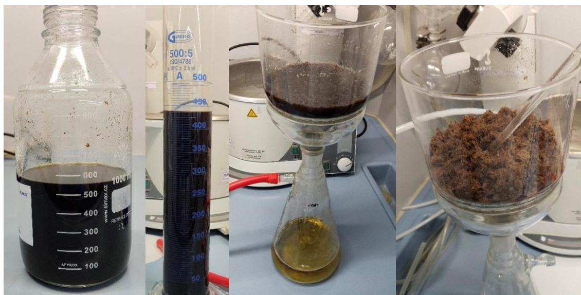
Figura 9: 1ª Imagen: Resultado del proceso de extracción organosolv. 2ª Imagen: Disolvente filtrado. 3ª Imagen: matraz Kitasatos y embudo Buchner durante el segundo lavado. 4ª Imagen: biomasa filtrada y lavada dos veces.
